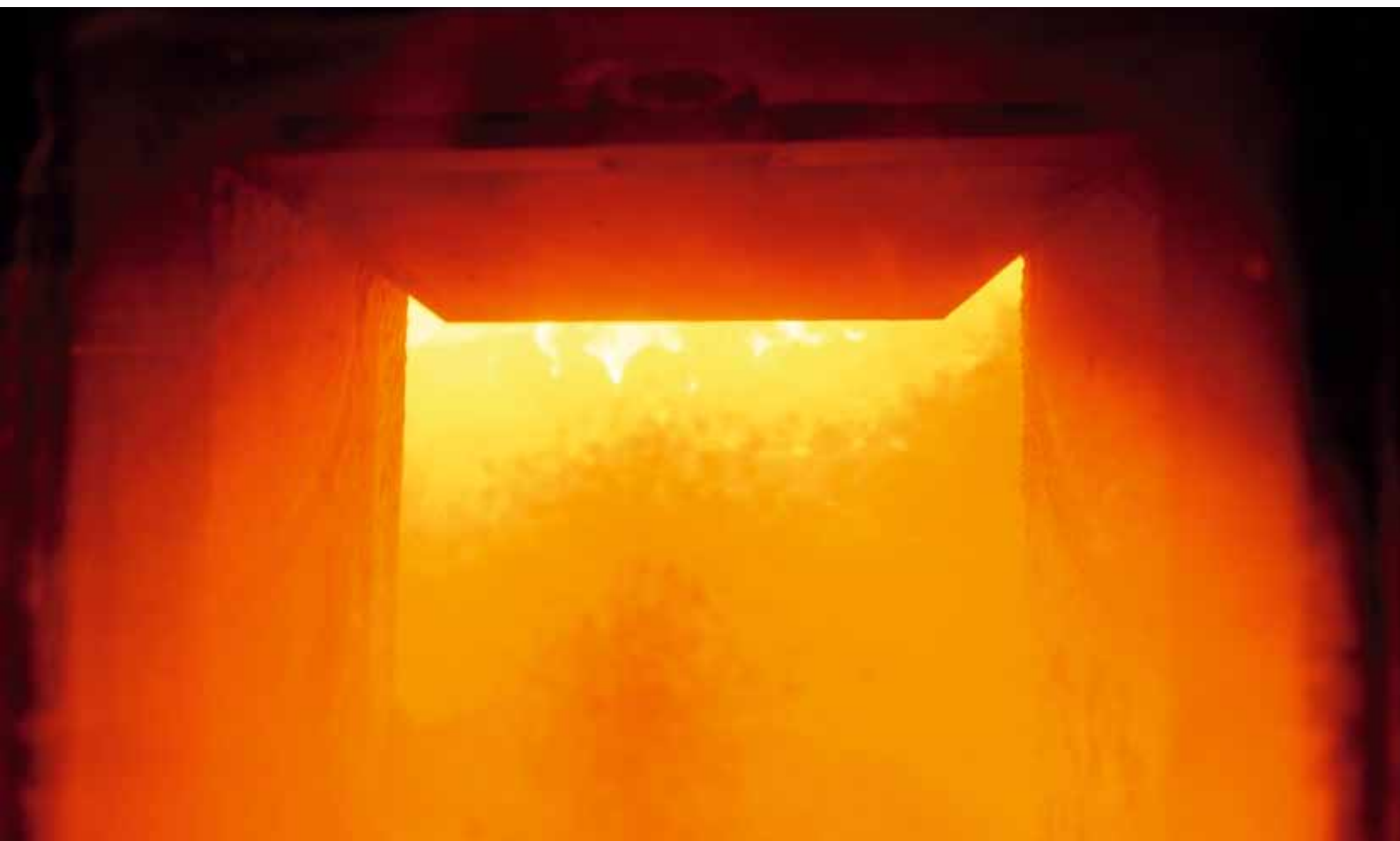
På selve rista i ovnen er det ca. 900 grader. Mens røykgassen kan komme opp i 1300-1400 grader enkelte steder.
