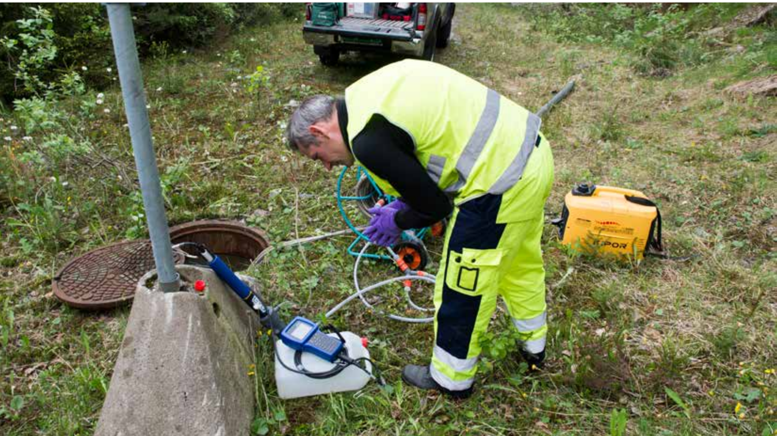
Prøvetaking på Støleheia Avfallsanlegg – grunnvannsbrønn nedenfor deponiet: Martin Due Hauge fra Labnett.
