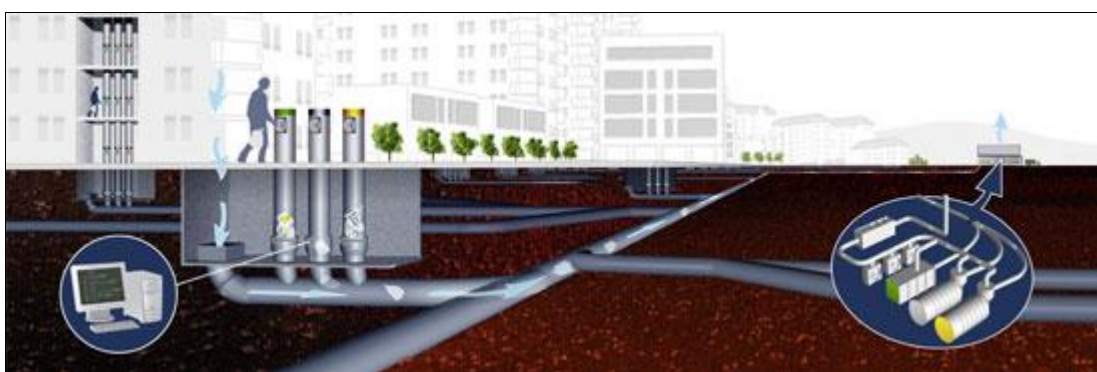
Figur 4.1 Stasjonært avfallssug. (Kilde: www.envac.no )
